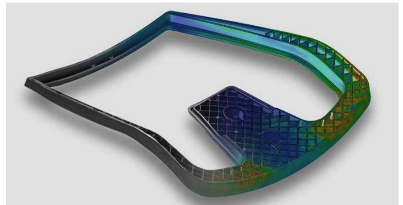
Belastungssimulation der Kunststoff-Rückenlehne (Berechnung nach der Finite-Elemente-Methode)
